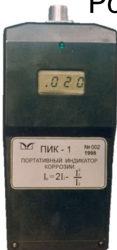
Портативні корозиметри ПІК-1, ПІК-2 та ІК-4п
