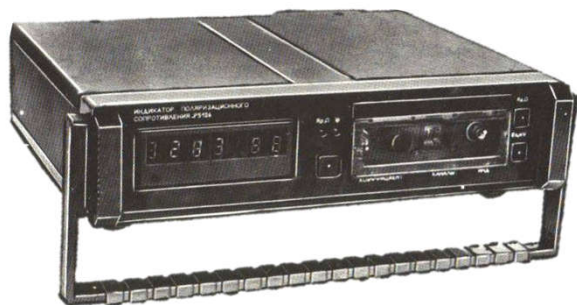
Лабораторний корозиметр P5126
